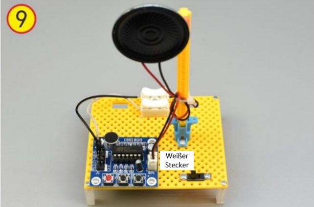
9 Vervollständige den Stromkreis wie bei Schritt 5 zu sehen. Befestige den Lautsprecher mit Klebeband an der orangen Fläche. Stecke den weißen Stecker auf die Platine. Bündele die Kabel mit Kabelbinder an der Stange.
