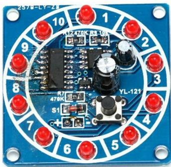
Funktion: Durch Knopfdruck wird das Glücksrad gestartet und eine Zufallszahl entsteht.
