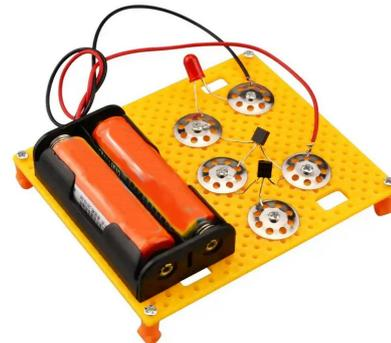
Funktion: Anzeige der Leitfähigkeit der Haut, Lügendetektor
