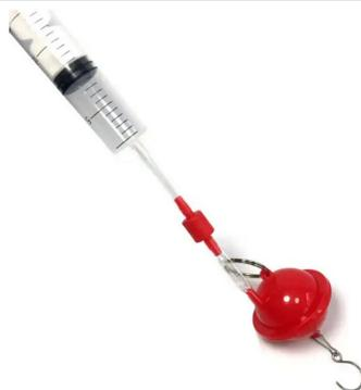
Funktion: die Luft zwischen den Halbkugeln wird abgesaugt, wodurch diese kaum mehr zu trennen sind
