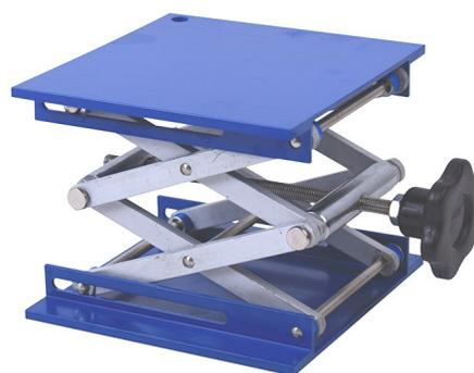
Stellfläche: 15 cm x 15 cm, maximale Höhe: 25 cm, mit Stell-schraube, Material: Stahl, z. B. für Versuche mit dem Über-laufgefäß
