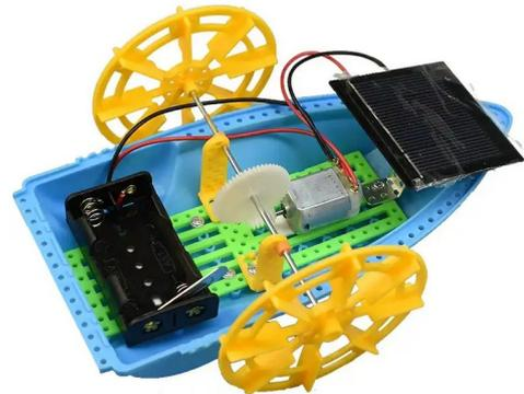
Funktion: zwei Solarzellen treiben ein Boot an, auch Batteriebetrieb möglich
