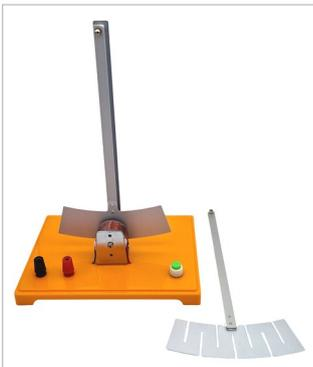
Die SchülerInnen schwenken zuerst eine massive und danach eine geschlitzte Aluminiumplatte in das Magnetfeld eines Elektromagneten ein. Dabei erkennen sie, dass die massive Platte stärker abgebremst wird. Mithilfe des Begleitmaterials werden die Vorgänge genau erklärt.
