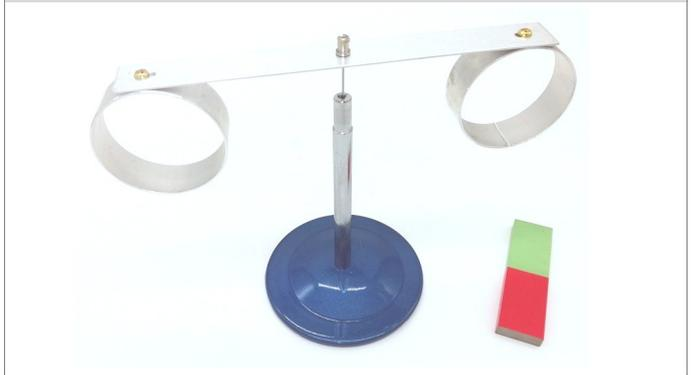
Apparatur mit zwei Ringen (durchgehend, geschlitzt), Stabmagnet, zum Nachweis der lenzschen Regel
