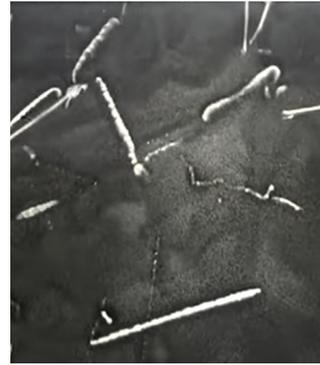
Sichtfeld: 10 x 10 cm, keine Expansion erforderlich, als Demonstrations- und Schülerexperiment geeignet, einfache Durchführung (unten Trockeneis einfüllen, oben Alkoholmischung auf Filz geben, wenige Minuten warten), sehr gut sichtbare Spuren, Betrieb über einige Minuten (dann ggf. nachfüllen), Abmessungen: 13 x 13 x 16 cm, seitliche Beleuchtung, inkl. 250 ml Alkoholmischung, mit Anleitung, zusätzlich Trockeneis benötigt
