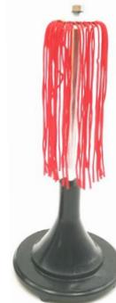
Fäden stehen durch elektrostatische Abstoßung sternförmig
