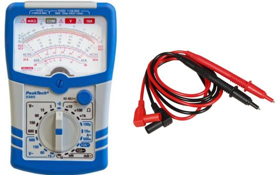
Multimeter Peaktech P3385, AC und DC, Spannung (1 mV bis 600 V), Stromstärke (auch AC, 1  $\mu$ A bis 10 A), weitere Details, s. Webshop
