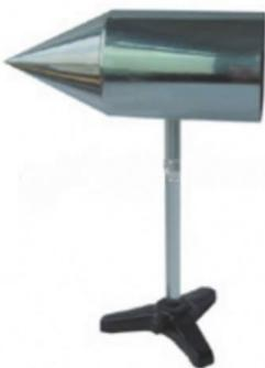
Länge: 15 cm, mit Isolierstange und Standfuß, zur Untersuchung der Spitzenentladung (z. B. „Elektrischer Wind“), zum Anschluss an Hochspannungsquelle
