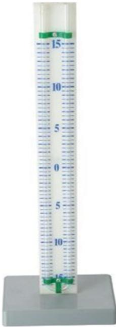
Skala: -15 bis 15 hPa, Material: Glas/Kunststoff, Höhe: 35 cm, mit Pipette zur Befüllung bis zur Nullmarke dazu passend: Ph-M-20-002
