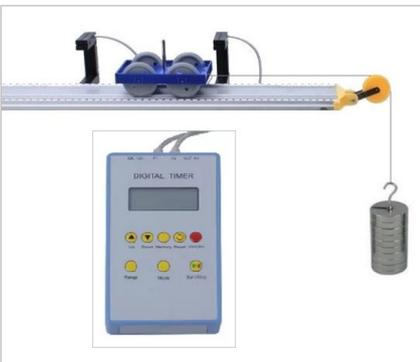
Die SchülerInnen untersuchen quantitativ den Zusammenhang zwischen Masse und Beschleunigung. Die Messung wird elektronisch mithilfe von Lichtschranken durchgeführt. Bei der numerischen Auswertung wird die indirekte Proportionalität und die Gesetzmäßigkeit des Aktionsprinzips erkannt. In dem Set sind zudem die Bauteile (Stativ, Winkelmesser) enthalten um Versuche in der schiefen Ebene durchzuführen.
