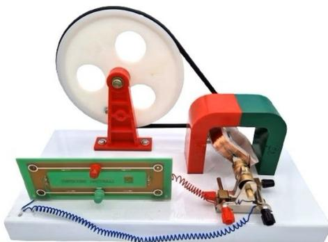
Außenpolgenerator, Abmessungen 28 cm x 18 cm x 15 cm, LEDs zeigen die aktuelle Stromrichtung an, Schleifkontakte einstellbar, dadurch Wechselstrom oder pulsierender Gleichstrom einstellbar
