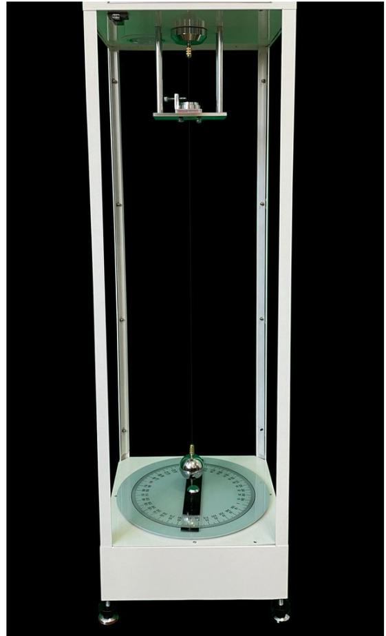
Foucault-Pendel zum Nachweis der Erdrotation, bereits wenige Minuten genügen zum Nachweis, sehr präzise Winkelmessung möglich, mit Charron-Ring, für längere Beobachtungen: elektromagnetische Anregung des Pendels, Genauigkeit des Ergebnisses: ca. 5 %, Maße: 140 cm x 40 cm x 40 cm, inkl. Anleitung
