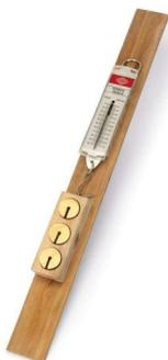
Zur Untersuchung der Einflussfaktoren auf die Reibungskraft, Masse und Fläche des Reibungskörpers veränderbar, Inhalt: Reibungsfläche (50 cm), Reibungsklotz, mit Haken, 3 x Gewichte 50 g, Federkraftmesser
