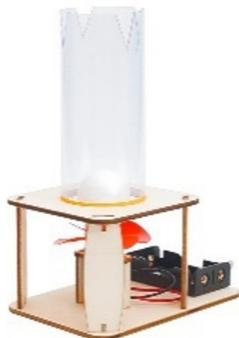
Funktion: ein Elektromotor treibt einen Propeller an, der Luftstrom lässt einen Ball schweben
