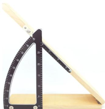
Versuchsapparatur Schiefe Ebene, Winkel- und Höhenskala, inkl. Umlenkrolle, Material: Holz, Edelstahl
