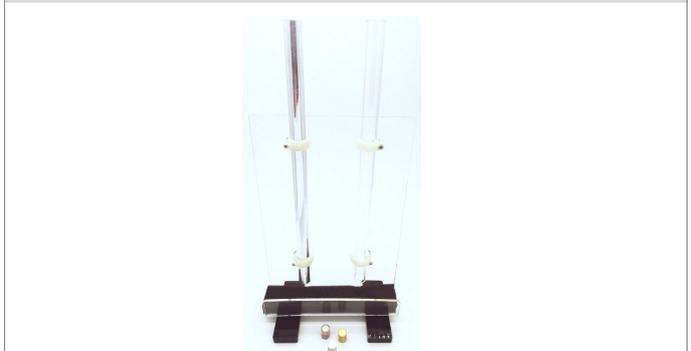
Apparatur mit Aluminiumrohr und Plexiglasrohr, zylinderförmige Fallkörper, klassisches Beispiel für Wirbelströme
