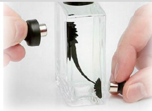
Ferrofluid in Glasgefäß, mit 2 Neodym-Magneten
