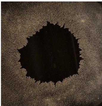
Zur Durchführung des Ölfleckversuchs: Berechnung der ungefähren Größe von Atomen/Molekülen, Inhalt: 20 ml Ölsäure-Leichtbenzin-Mischung (1:2000), 10 g Bärlappsporen, Streuer, Glaspipette, Schale, inkl. Anleitung
