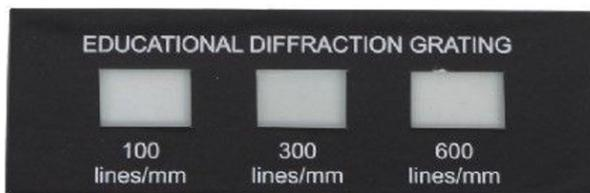
Optisches Gitter für Beugung, 3 Bereiche: 100/mm, 300/mm, 600/mm, Abmessungen: 9 cm x 3 cm
