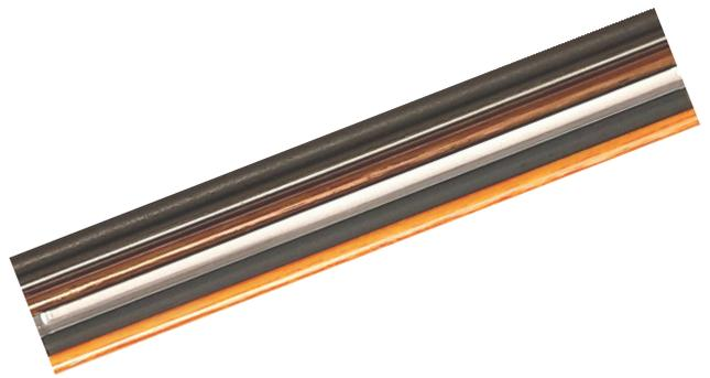
Stahl, Kupfer, Glas, PVC, Graphit, Holz, Länge: je 10 cm, Durchmesser: je 3 mm, zur Untersuchung der Leitfähigkeit
