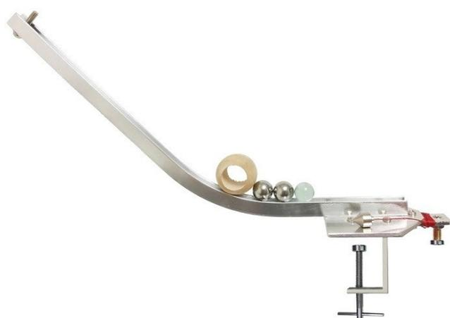
Zur Untersuchung der Impulserhaltung und der kinetischen Energie bei Stößen (Berechnung der Geschwindigkeit anhand der beobachteten Flugbahn), auch zum Vergleich von elastischen und unelastischen Stößen, Inhalt: gebogene Metallschiene mit Tischhalterung und verstellbarer Zielhalterung, Lot, 2 Stahlkugeln, Glaskugel, hohle Holzkugel
