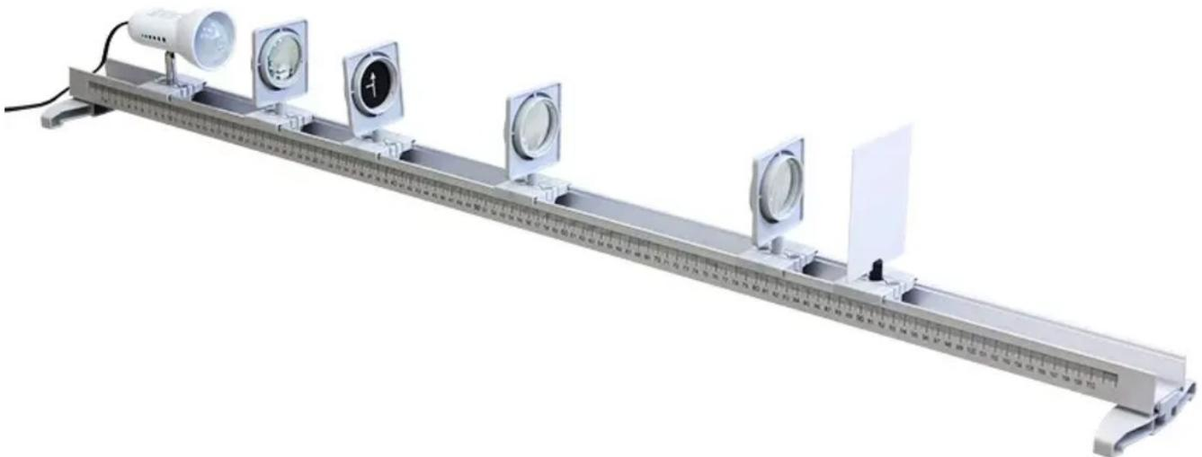
Für Experimente zur Abbildung durch Sammellinsen, Untersuchung der Einflussfaktoren auf die Merkmale und die Lage des Bildes mit dem Ergebnis der Unterscheidung der einzelnen Abbildungsfälle ( $g > 2f$ , usw.)
