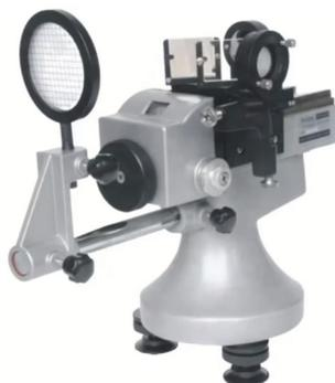
Vereinigt das historisch wichtige Michelson-Interferometer und das hochauflösende Fabry-Perot-Interferometer in einem kompakten Aufbau, kein Zusammenbau erforderlich, Präzisions-Einstellung des Spiegels für 0,0001 mm Auflösung
