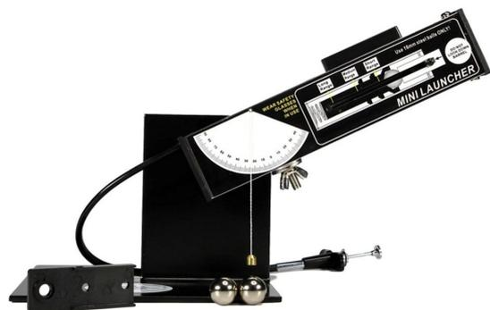
Abschussvorrichtung mit Winkelmesser und Auslosер, Untersuchung des waagrechten und schiefen Wurfs, Material: Edelstahl, 3 Anfangsgeschwindigkeiten einstellbar, mit 2 Kugeln
