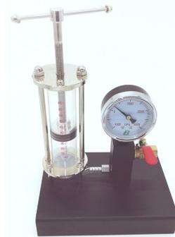
Apparatur zur Untersuchung des Zusammenhangs von Druck und Volumen, Auswertung der Messreihe ergibt das Gesetz von Boyle-Mariotte, Abmessungen: 20 cm x 15 cm x 10 cm
