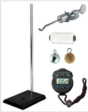
Hiermit untersuchen die SchülerInnen die Schwingung des Fadenpendels. Der Einfluss der Auslenkung, der Masse des Pendelkörpers und der Fadenlänge auf die Schwingungsdauer werden untersucht.
