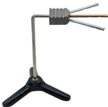
Zur Untersuchung des Vorgangs der Wärmeleitung und Vergleich der Wärmeleitfähigkeit bei Eisen, Aluminium und Kupfer, Auswölbung in gleichen Abständen zur Anbringung von Kugeln mit Wachs, Höhe: 15 cm
