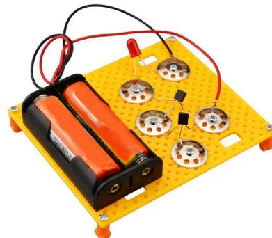
Funktion: Anzeige der Leitfähigkeit der Haut, Lügendetektor
