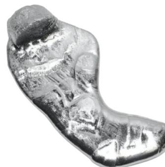
25 g, Reinheit: 99,99 %, Schmelzpunkt: 30 °C, zur Demonstration der Aggregatzustandsänderung von fest zu flüssig, z. B. in einem Glasgefäß mit der Temperatur der Hände
