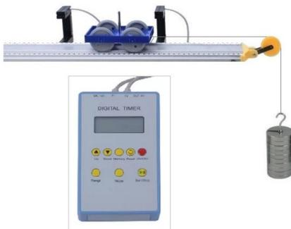
Zum Nachweis des 2. newtonschen Gesetzes, Inhalt: Schiene mit Umlenkrolle, Wägelchen, Messgerät inkl. Netzteil, 2 Lichtschranken, Träger, Gewichtsstücke, Schnur
