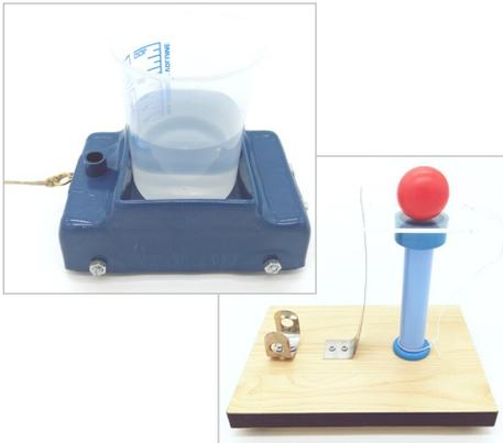
Die SchülerInnen untersuchen wie Festkörper und Flüssigkeiten auf die Änderung der Geschwindigkeit bzw. der Bewegungsrichtung reagieren. Damit entdecken sie das Prinzip der Trägheit. Der zweite Versuch handelt von der Kugel, die trotz der schnellen Bewegung der Unterlage ihre Position beibehält.
