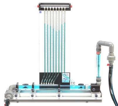
Vollständige Apparatur zur Bestätigung der Bernoulli-Gleichung, inkl. Pumpe, mit Anleitung
