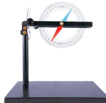
Länge der Nadel: 10 cm, Gesamtgröße: 20 cm, drehbar und schwenkbar, zur Bestimmung des Inklinationswinkels
