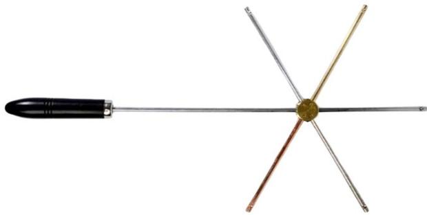
Zur Untersuchung der Wärmeleitfähigkeit von Aluminium, Messing, Eisen, Nickel und Kupfer, wird mit der Mitte über eine Flamme gehalten, mit Handgriff
