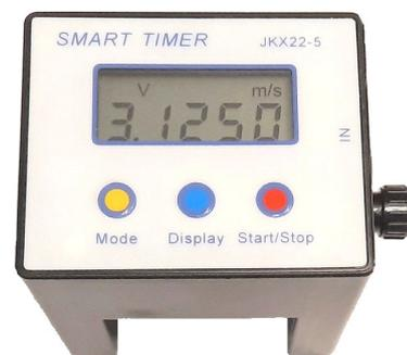
Messung von Geschwindigkeit, auch weitere Modi: Zeit, Beschleunigung, Lichtschranken integriert, zum Halten oder zur Befestigung an Stativ, inkl. Batterien (4 AAA), mit Anleitung
