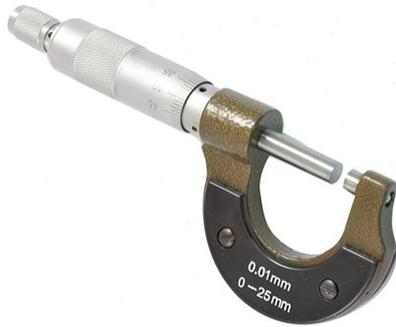
Bügelmessschraube, Grob- und Feineinstellung, gehärtete und geschliffene Messflächen, Messbereich: 25 mm, Ablesegenauigkeit: 0,01 mm, Material: Edelstahl, mit Box
