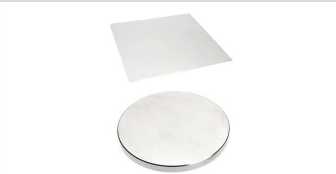
Scheibenförmiger Magnet (Neodym) und Aluminium-Platte (5 cm x 5 cm), Platte landet sanft und geräuschlos auf der Magnetscheibe, als Beispiel für Wirbelströme
