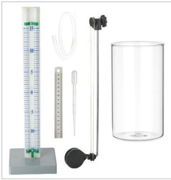
Die SchülerInnen untersuchen mit diesem Set den Zusammenhang zwischen Schweredruck und Eintauchtiefe. Als Druckmessgerät wird ein U-Rohr verwendet.
