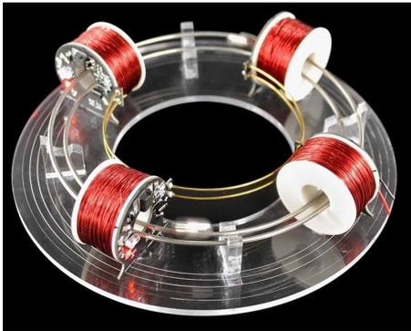
Durchmesser: 30 cm, 4 Spulen, Stromfluss/Magnetfeld der Spulen wird mithilfe der Lichtschranke geregelt, Geschwindigkeit: ca. 25 Bahnen pro Minute, mit Kugeln, fertig, inkl. Netzteil
