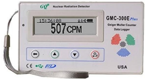
GQ GMC-300E Plus, Zählrohr integriert,  $\beta$ - und  $\gamma$ -Strahlung, verschiedene Modi: Zählen, Diagramm, Dosis usw., zusätzlich akustisches und optisches Signal, Übertragung an PC möglich (Software kostenlos), Akku integriert, mit USB-Kabel
