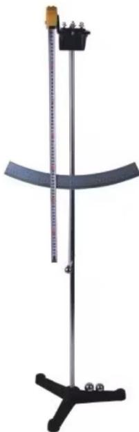
Zur Untersuchung der Schwingung des Fadenpendels, vollständiger Versuchsaufbau, veränderbare Fadenlänge, Maßband zur Messung der Fadenlänge, Kugeln verschiedener Massen, mit Winkelmesser zur Messung der Auslenkung, Material: Edelstahl, Höhe: 110 cm
