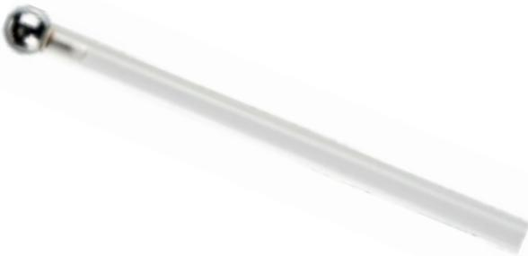
Konduktorkugel mit Isoliergriff, Länge: 20 cm, zur Übertragung von Ladungen
