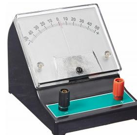
Messbereich: -50 mV bis 50 mV, 4 mm-Anschlussbuchsen
