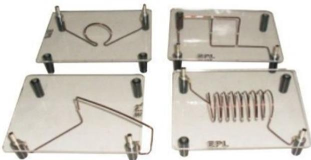
Untersuchung des Magnetfelds bei verschiedenen Leiterformen, 4 mm-Anschlussbuchsen
