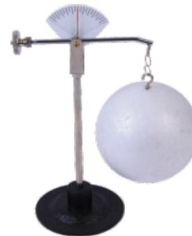
Zur Demonstration der Auftriebskraft auf Körper durch die uns umgebende Luft, die Waage zeigt unter der Vakuumglocke ein Ungleichgewicht an aufgrund der fehlenden Auftriebskraft, Waage mit Feinjustierung des Gegengewichts, Größe: 10 cm
