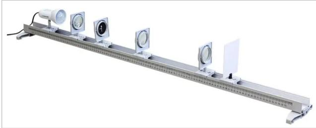
Mit dieser optischen Bank setzen sich die SchülerInnen genauer mit der Abbildung durch Sammellinsen auseinander. Dabei wird der Einfluss der Gegenstandsweite auf die Merkmale und die Lage des Bildes untersucht. Daraus ergibt sich die Unterscheidung der einzelnen Abbildungsfälle ( $g > 2f$ , usw.).
