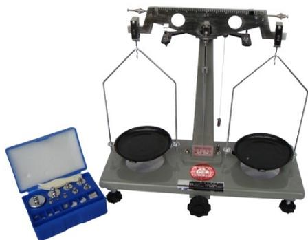
Messbereich: 200 g, Ablesegenauigkeit: 20 mg, Material: Metall, mit Gewichtssatz in Box, Material Gewichte: Stahl, vernickelt
