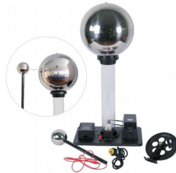
Erzeugung hoher Gleichspannungen (200 kV), für Versuche der Elektrostatik, Antrieb durch Motor (regelbar) oder Kurbel, 4 mm-Anschlussbuchsen, mit Zubehör: Konduktorkugel auf Isolierstab, Erdungskabel, Netzteil, Anleitung, Größe: 70 cm
