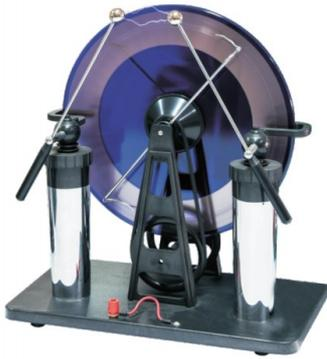
Nach dem Prinzip von Wimshurst, Erzeugung hoher Gleichspannungen ( $> 100 \text{ kV}$ ), klassischer Aufbau mit 2 Leidener Flaschen und Funkenstrecke, Antrieb durch Handkurbel, Blitze bis zu 10 cm Länge, Größe: 45 cm, mit Anleitung
