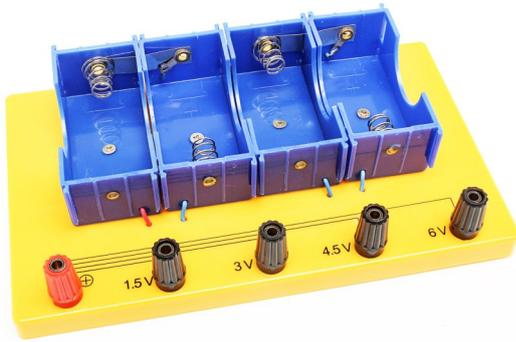
Für 4 D-Batterien, abnehmbare Spannungen: 1,5 V, 3 V, 4,5 V und 6 V, 4 mm-Anschlussbuchsen
