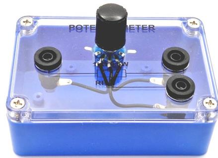
0  $\Omega$  bis 1000  $\Omega$  einstellbar, 4 mm-Anschlussbuchsen
