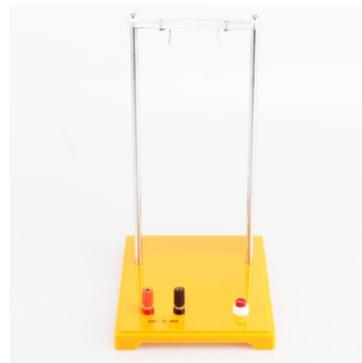
Aufbau zur Untersuchung von Leitern im Magnetfeld, Größe: 20 cm, mit Ösen zur Aufhängung von Leiterschaukel/Spule, 4 mm-Anschlussbuchsen, Drucktaster zum Schließen des Stromkreises
