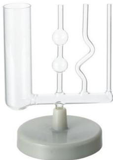
4 verschiedene Röhren, Material: Glas, zum Nachweis der einheitlichen Füllhöhe trotz unterschiedlicher Röhrenform, hydrostatisches Paradoxon
