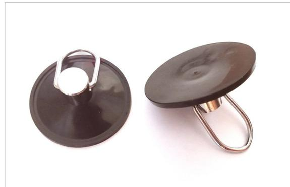
Die SchülerInnen erfahren den Luftdruck, indem sie die Luft zwischen den beiden Hälfte durch Zusammenpressen entweichen lassen, und dann probieren sie auseinanderzuziehen. Die Kraftwirkung durch den Luftdruck ist so groß, dass dies nicht gelingt.
