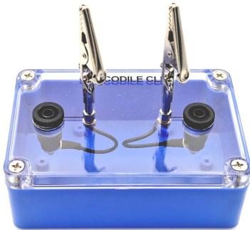
Abmessungen: 10 cm x 3 cm x 7 cm, 4 mm-Anschlussbuchsen, sehr geringer Widerstand zudem magnethaftend, somit auch für Demonstrationsexperimente nutzbar
