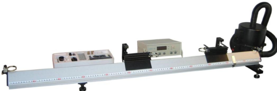
Zur Untersuchung von Stößen (elastisch, unelastisch) und Herleitung der Gesetzmäßigkeiten der Impulserhaltung, ebenso geeignet für Versuche zu den Themen: Geschwindigkeit, Beschleunigung, Erdbeschleunigung, 2. newtonsches Gesetz, Energieerhaltung usw., Material Luftkissenbahn/Gleiter: Aluminiumlegierung, Inhalt: Luftkissenbahn (1,2 m), 2 Gleiter, sämtliches Zubehör (Liste der Einzelteile s. Webshop), Luftstromerzeuger, Lichtschranken, Zeitmesser, Anleitung
