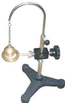
Zur Vorführung der Volumenzunahme von Festkörpern nach Wärmezufuhr, die Kugel passt nach dem Erhitzen nicht mehr durch den Ring
