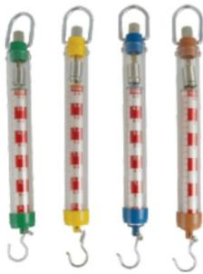
Federkraftmesser, mit Nullpunktkorrekturschraube
