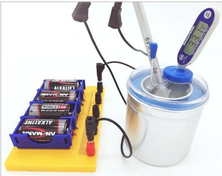
Die SchülerInnen erforschen in drei Versuchen die Zusammenhänge zwischen zugeführter Wärme und Temperaturänderung, Masse und Stoffart. Sie werten jeweils die Messreihen aus und erhalten Ergebnisse, mit denen das Erwärmungsgesetz hergeleitet wird.
