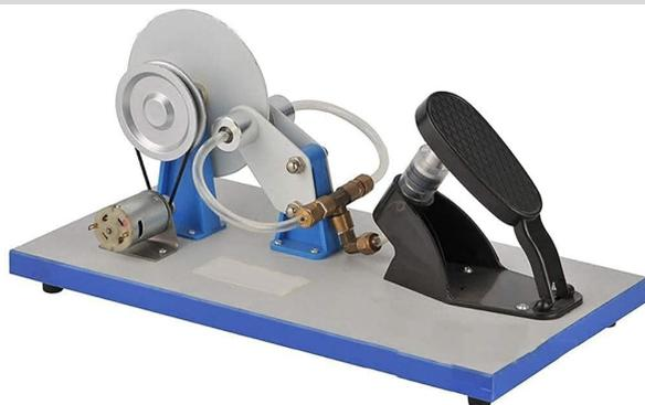
Funktionsmodell einer Bremsanlage, Abmessungen: 30 cm x 18 cm x 17 cm, Kraftübertragung durch Druck in einem Medium (Luft oder Flüssigkeit), Radantrieb durch Elektromotor, 6 V erforderlich (z. B. Netzgerät)
