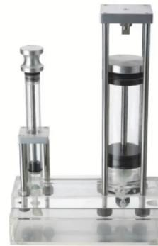
Funktionsmodell der hydraulischen Presse, Vervielfachung der Kraft nach dem pascalschen Gesetz, Abmessungen: 28 x 20 x 8 cm, Einsatz zum Schneiden von Metall, inkl. Eisenstäbe, mit Anleitung
