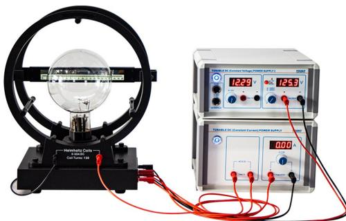
Vollständiger Versuchsaufbau, nach J. J. Thomson, zur Messung der spezifischen Ladung  $e/m$  des Elektrons, einfache Versuchsdurchführung, Inhalt: Netzgeräte, Fadenstrahlrohr, Helmholtz-Spulen, Kabel, Anleitung
