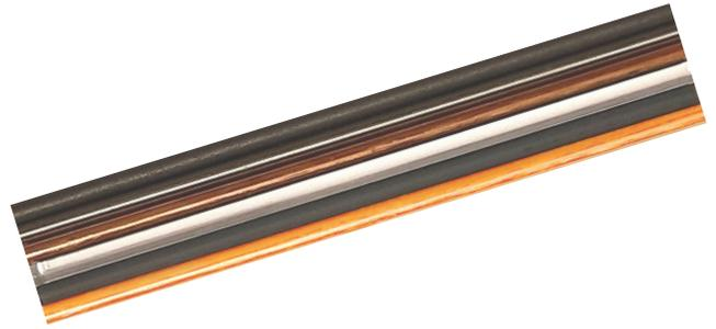
Stahl, Kupfer, Glas, PVC, Graphit, Holz, Länge: je 10 cm, Durchmesser: je 3 mm, zur Untersuchung der Leitfähigkeit
