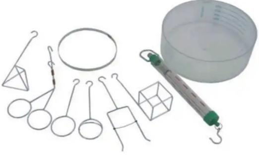
9-teiliges Set für Experimente zur Oberflächenspannung, mit Schale und Kraftmesser
