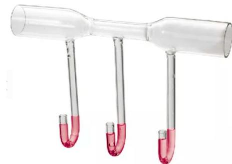
Zur Untersuchung des Venturi-Effekts, Material: Glas, Länge: 15 cm
