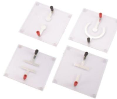
4 Platten mit Elektroden unterschiedlicher Form, zur Untersuchung der Struktur von elektrischen Feldlinien, 4 mm-Anschlussbuchsen, Abmessungen: je 10 cm x 10 cm, zum Anschluss an Hochspannungsquelle
