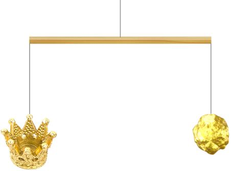
Aufbau zur Geschichte von Archimedes und der Krone, Krone und "Gold"-Stück mit gleicher Masse sind auf einer Waage, beim Eintauchen ins Wasser hebt sich die Krone, Abmessungen: Stange 15 cm, Körper 3-4 cm
