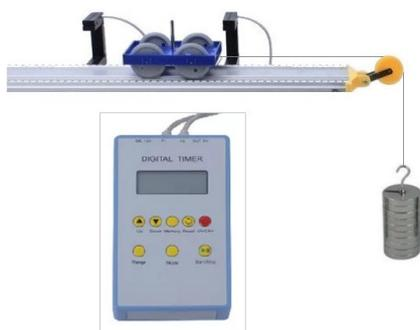
Messung der Beschleunigung, Inhalt: Schiene mit Umlenkrolle, Stativmaterial zur Neigung mit Winkelmesser, Wagelchen, Messgerat (inkl. Netzteil), 2 Lichtschranken, inkl. Anleitung, zusatzlich benotigt: Gewichtstrager mit Massenstucken
