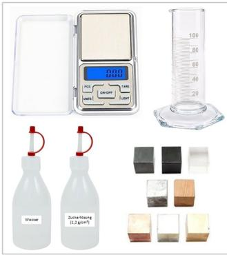
Mit diesem Set untersuchen die SchülerInnen bei zwei verschiedene Stoffen den Zusammenhang zwischen Volumen und Masse. Sie werten die Messreihen numerisch und grafisch aus und erkennen dadurch die Proportionalität zwischen den Größen. Die Würfel aus unterschiedlichen Stoffen ermöglichen einen direkten Vergleich.
