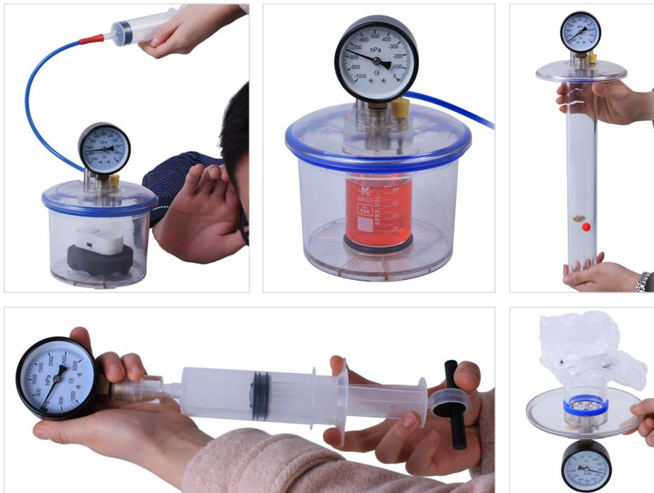
Dieses Set ermöglicht viele spannende Versuche: Verschwinden von Schall bei niedrigem Luftdruck, Sieden bei Raumtemperatur, freier Fall von Feder und Kugel, Zusammenhang zwischen Druck und Volumen
