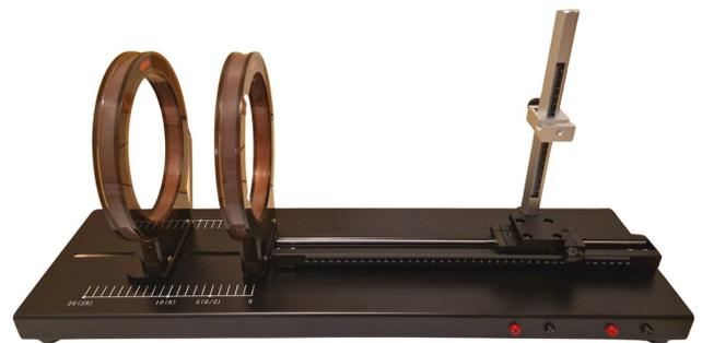
2 Spulen (Radius 100 mm, 500 Windungen, max. 1 A), 4 mm-Anschlussbuchsen, Abstand zwischen den Spulen verstellbar bis 200 mm, Skala aufgedruckt, verstellbare Halterung für Hall-Sonde, Abmessungen: 77 cm x 22 cm x 37 cm
