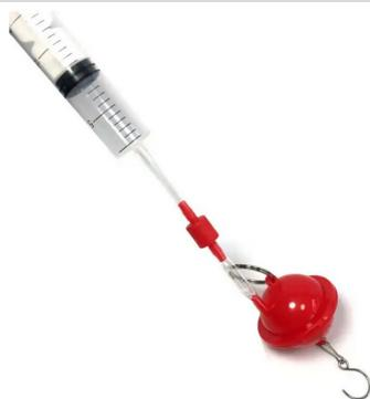
Funktion: die Luft zwischen den Halbkugeln wird abgesaugt, wodurch diese kaum mehr zu trennen sind
