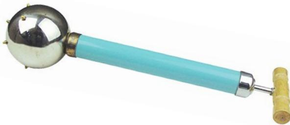
Gefäß mit verschiebbarem Kolben zur Demonstration der gleichmäßigen Druckverteilung in Flüssigkeiten nach allen Richtungen
