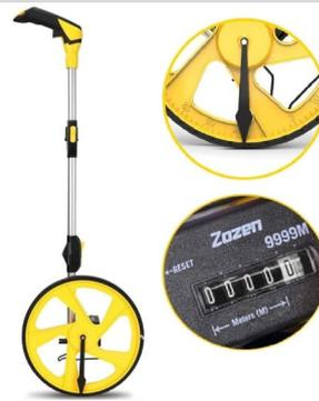
Zählwerk (für ganze Meter), Rad mit cm-Skala, Messbereich: 10 km, Ablesegenauigkeit: 1 cm, Material: Kunststoff/Metall
