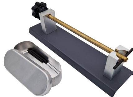
Demonstration der auftretenden Kräfte durch die Längenänderung beim Absinken der Temperatur, Länge: 20 cm, mit Ersatzbolzen
