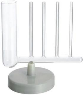
Zur Vorführung des Zusammenhangs zwischen Kapillarenradius und Steighöhe, Höhe: 15 cm, Material: Glas
