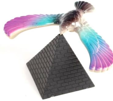
Zur Demonstration des Schwerpunkts, 2-teilig: Vogel und Pyramide, der Schwerpunkt des Vogels befindet sich bei der Schnabelspitze mit der er auf der Pyramide liegt, Breite: 12 cm, Höhe: 8 cm, Material: Kunststoff
