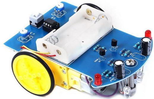
Funktion: Das Fahrzeug folgt mithilfe von Sensoren einer Linie.
