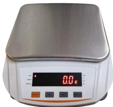
Messbereich: 2000 g, Ablesegenauigkeit: 0,1 g, Display mit leuchtenden Ziffern, Abmessungen Teller: 143 mm x 192 mm, Abmessungen gesamt: 280 mm x 180 mm x 80 mm, Tara-Funktion, Betrieb mit (Akku-)Batterien oder Netzteil
