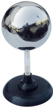
Kugel innen hohl, Kugeldurchmesser: 10 cm, mit Isolierstange und Standfuß, für zahlreiche Versuche der Elektrostatik
