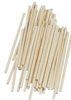
60 Stück, Länge: 10 cm, Durchmesser: 4 mm, Material: Holz, zur Verwendung als Rollen unter den Reibungsklotzen zur Untersuchung der Rollreibung
