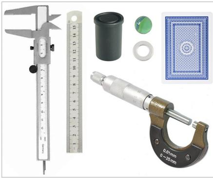
Die SchülerInnen erlernen den Umgang mit den Längenmessgeräten Lineal, Messschieber und Mikrometerschraube und verwenden sie zur Messung von Objekten. Auch die gültigen/geltenden Ziffern und die Auswertung von Messreihen werden behandelt.
