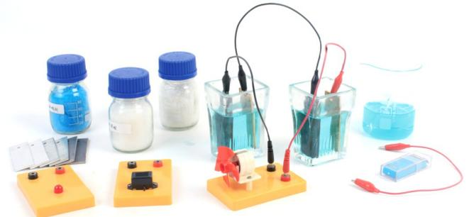
Für folgende Experimente: Leitfähigkeit Flüssigkeiten, Elektrolyse, Verkupferung, elektrochemisches Element, Batterie
