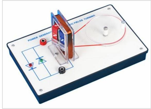
Durch das Kurbeln wird der Magnet in der Spule gedreht. Mithilfe der beiden LEDs ist jeweils die aktuelle Stromrichtung des Wechselstroms zu sehen. Damit wird der Wechselstrom besonders anschaulich.
