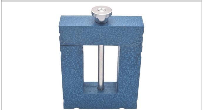
U-Kern und I-Kern, Material: Weicheisen geblättert, mit Spannvorrichtung passend zu den Spulen Ph-E-7-002
