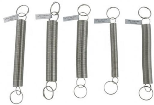
5 Federn mit unterschiedlichen Federkonstanten (2,5 N/m, 5 N/m, 10 N/m, 15 N/m und 25 N/m), für Experimente zum hookeschen Gesetz, Schwingungen usw.
