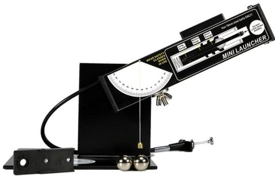
Abschussvorrichtung mit Winkelmesser und Auslöser, Untersuchung des waagrechten und schiefen Wurfs, Material: Edelstahl, 3 Anfangsgeschwindigkeiten einstellbar, mit 2 Kugeln
