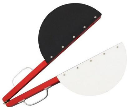
Startklappe zur Durchführung eines Versuchs zur Messung der Schallgeschwindigkeit, z. B. bei einer Entfernung von 100 m durch Messung des Laufzeitunterschieds
