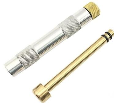
Durch das schnelle Komprimieren der Luft erhöht sich die Temperatur so stark, dass ein Stück Zunder entflammt wird.
