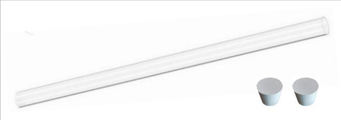
Zur Untersuchung des Zusammenhangs von Zeit und zurückgelegtem Weg, das Rohr wird fast vollständig mit Wasser gefüllt und verschlossen, es wird leicht zur Ebene geneigt und in gleichen Zeitintervallen wird die Position der Luftblase mit einem Stift markiert, die Auswertung ergibt die direkte Proportionalität, ein zweiter Versuch mit etwas größerer Neigung ergibt eine schnellere Bewegung, Inhalt: Plexiglasrohr: Länge 1,00 m, Durchmesser 1,3 cm/ 1,0 cm, 2 Stopfen
