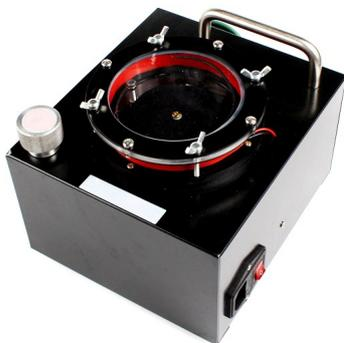
Expansionsnebelkammer, Sichtfeld:  $d = 10$  cm, Expansion mit seitlichem Hebel, gut sichtbare Spuren für mehrere Sekunden, Beleuchtung des Sichtfeldes, mit Anleitung
