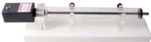
Apparatur zur Untersuchung von stehenden Schallwellen, an einem Ende befindet sich ein Tonerzeuger, mit einem Kolben wird die Länge der Luftsäule verändert, bei bestimmten Längen ist eine deutliche Tonverstärkung zu hören, mit Anleitung
