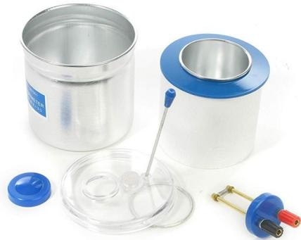
Doppelwandig, mit Isolierschicht, 150 ml einfüllbar, Abmessungen Gefäß: Höhe: 12 cm, Durchmesser: 10 cm, mit Heizwendel (6 V, 15 W), Rührer, Stopfen mit Bohrung für Thermometer
