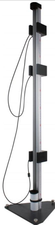
Fallvorrichtung mit Zeitmessgeraten/Lichtschranken, Untersuchung des freien Falls und Bestimmung der Erdbeschleunigung, Material: Edelstahl, Hohe 1,25 m, Ablesegenauigkeit: 0,01 s, inkl. Batterien (3 x 4 AAA)
