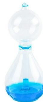
Zur Vorführung der Volumenänderung von Gas, die Berührung mit der Hand führt zur Ausdehnung der Luft im Inneren und schneller Verschiebung der Flüssigkeit nach oben, Größe: 15 cm
