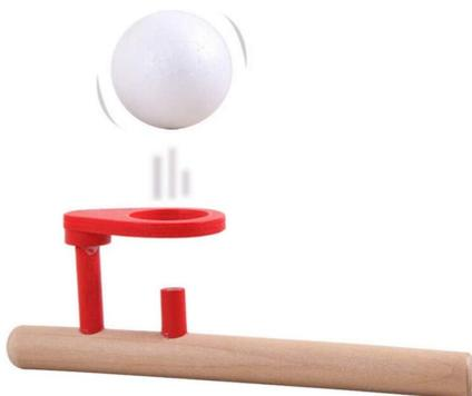
Schwebender Ball im Luftstrom, Demonstration zu dem Gesetz von Bernoulli, durch die erhöhte Strömungsgeschwindigkeit sinkt der Druck ab und der Ball wird zum Luftstrom hin gesaugt, Material: Holz, Kunststoff
