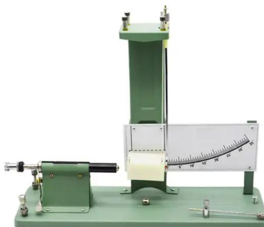
Apparatur mit Federpistole und Pendelkörper, die Kugel aus der Federpistole trifft auf den Pendelkörper (mit Gummieinlage) und lenkt diesen aus, der Zeiger markiert die weiteste Auslenkung, Berechnung der Anfangsgeschwindigkeit der Kugel mithilfe der Energie- und Impulserhaltung, anschließend Schuss ohne Pendelkörper und Vorhersage der Flugbahn/-weite mit der zuvor berechneten Geschwindigkeit, inkl. Stahlkugeln, mit Anleitung
