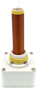
Höhe: 20 cm, Demonstration von Spitzenentladung, deutliche Leuchterscheinung am Drahtende, mit Soffitte (leuchtet in der Nähe), inkl. Netzteil
