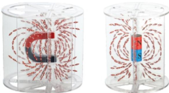
Zwei Demonstrationsgeräte zur dreidimensionalen Struktur des Magnetfelds von Stabmagnet und Hufeisenmagnet, mit Magneten
