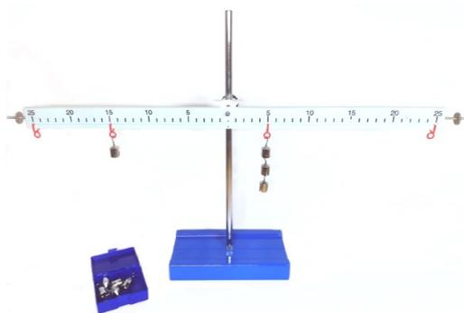
Versuchsaufbau zum Hebelgesetz, Inhalt: Standfuß, Stativstange, Hebelaufhängung, Hebelstange (mit Skala, Haken und Feinjustierung), Massenstücke 10x 10 g (jeweils mit Haken und Öse)
