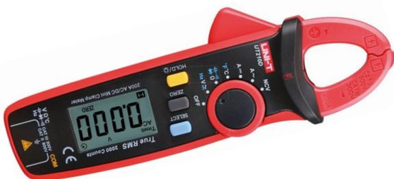
UNI-T UT210, AC/DC, zur kontaktlosen Messung von Stromstärke durch Umgreifen eines Kabels, Messbereiche einstellbar (2A, 20A, 200A), Ablesegenauigkeit: 1 mA, inkl. 2 AA-Batterien
