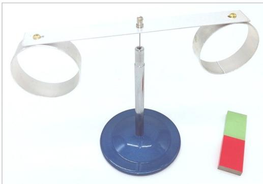
Die SchülerInnen bewegen den Stabmagneten zunächst relativ zu dem durchgehenden und anschließend zu dem geschlitzten Aluminium-Ring und beobachten die Auswirkungen. Mithilfe des Begleitmaterials werden die Vorgänge genau erklärt.
