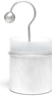
Höhe: 15 cm, Durchmesser: 7,5 cm, zur Untersuchung der Speicherung von Ladungen, bestehend aus 3 Teilen
