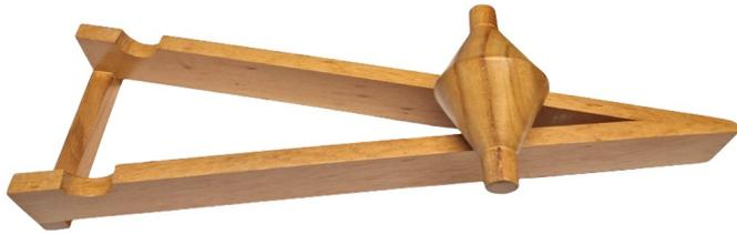
Zur Demonstration des Schwerpunkts, der Körper rollt die Rampe hoch, Länge: 45 cm, Material: Holz
