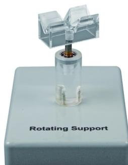
Drehlager, isoliert, Material: Kunststoff, z. B. Lagerung von Reibungsstäben zur Untersuchung von Anziehung und Abstoßung
