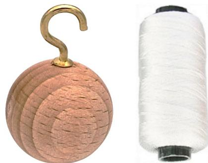
Zur Veranschaulichung der Schwingung z. B. einer Stimmgabel, die Holzkugel hängt an einem Faden und wird an die Stimmgabel gehalten
