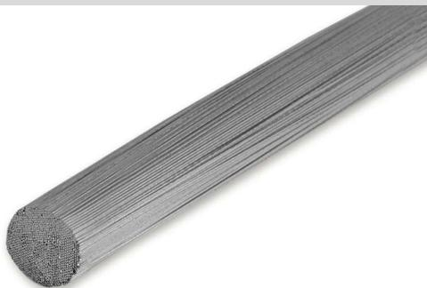
250 Eisendrähte, Länge: 20 cm, Durchmesser: 0,6 mm, für Versuche zur magnetischen Influenz (z. B. Magnetisierung durch Darüberstreichen)
