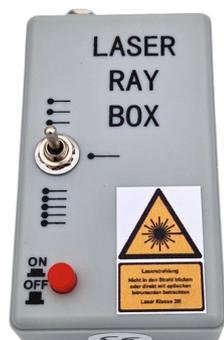
Erzeugung von parallelen Lichtstrahlen (1, 3 oder 5), Laser,  $\leq 1$  mW, rot, 640 nm, magnethaftend, inkl. Netzteil
