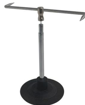
Länge: 10 cm, zur Untersuchung der Spitzenentladung, mit Standfuß, zum Anschluss an Hochspannungsquelle
