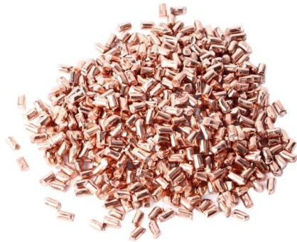
100 g Kupfer, Granulat, z. B. für Versuch zur Mischungstemperatur
