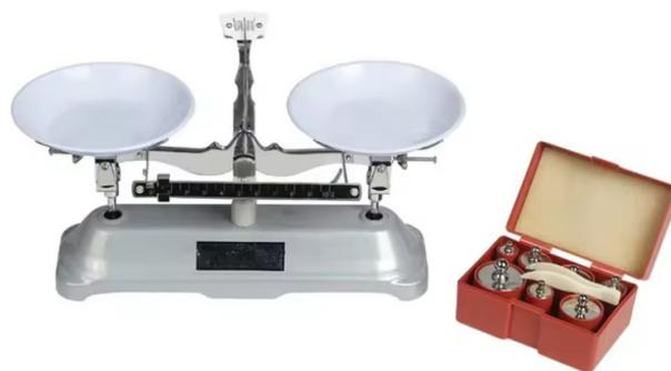
Messbereich: 2000 g, Ablesegenauigkeit: 1 g, Material: Metall, mit Gewichtssatz in Box, Material Gewichte: Stahl, vernickelt
