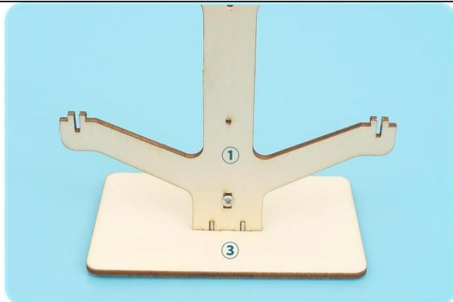
Schraube das Ergebnis mit 3 der 7 mm-Schrauben an das Bauteil 3 an.
