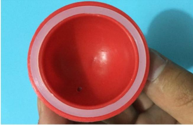
Bringe den Dichtungsring auf der Halbkugel an.
