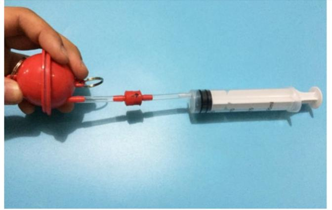
Verbinden die beiden Halbkugeln und halte sie zusammen. Saug mit der Spritze die Luft heraus. Untersuche dann wie stark die beiden Halbkugeln zusammenhängen.
