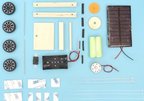
In der Abbildung sind die Teile des Sets zu sehen. Zusätzlich werden eine Schere, ein Schraubenzieher und ein Feuerzeug benötigt. Zusätzlich können Akku-Batterien (1,2 V AA) genutzt werden.
