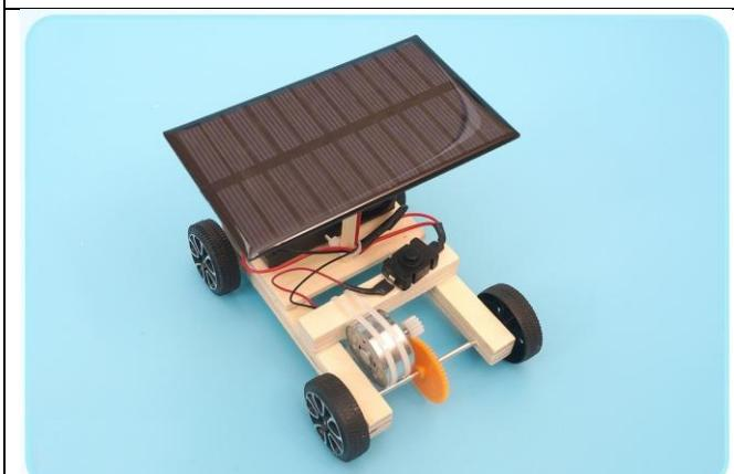
Klebe die Solarzelle auf die Halterung. Löse die Schutzfolie. Klebe den Schalter an.
