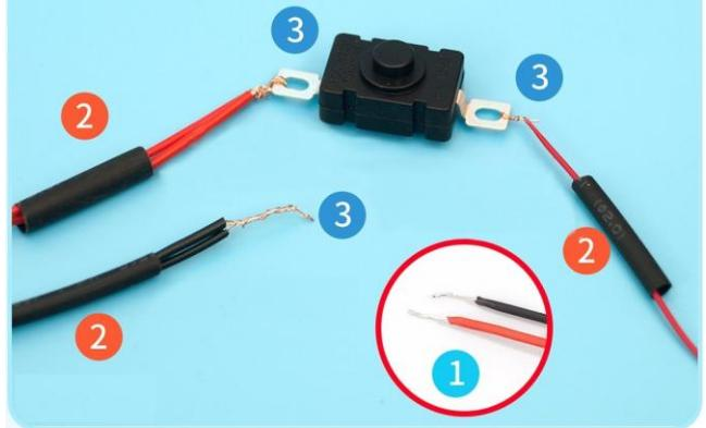
Entferne vorsichtig von den Enden der Leitungen etwa 1 cm der Isolation. Stecke die schwarzen Röhrchen über die Leitungen und verbinde wie zu sehen.
