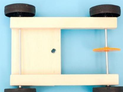
Baue die Teile wie abgebildet zusammen. Beachte, dass die Bohrung der Stangen so angebracht werden müssen, dass sie näher zur Platte zeigen.
