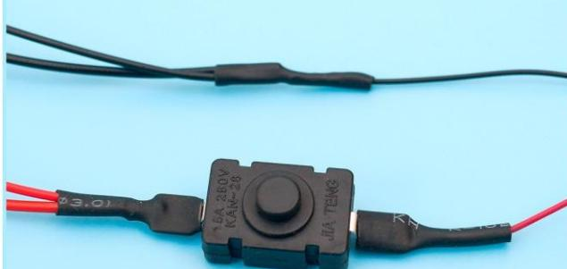
Schiebe die Röhrchen über die abisolierten Stellen und erhitze sie kurz. So schrumpfen sie und bilden die neue Isolation.
